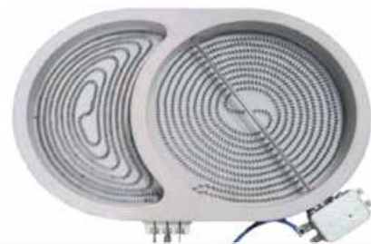
Sevalni grelec, v katerega sta vgrajena dva naša izdelka (3-polna sponka levo in enopolno ohišje termostata desno)
